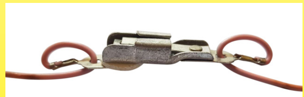
Temperaturbegrenzer für Calor-Heizmatten mit langsamer Unterbrechung, geeicht auf 80°C (ca. 1960). Man beachte die wasserdichte PVC-Hülle, die auf die Drähte geschweißt ist, und die Schleife, die durch die elektrischen Leiter gebildet wird, die durch ein Loch in jeder Klemme geführt werden - dies dient dazu, Zugspannungen auf den Draht zu vermeiden (Ultimheat-Sammlung).
