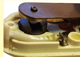
Ca. 1972. Schaltkasten der Firma Jidé in Limoges unter der Marke Jidéstat. Das erfolgreichste aller Systeme. Es ist sehr klein, einstellbar und in den Stecker integriert. Dies ist das einzige Modell mit einem Schnappmagnetkontakt. Es wurde erst in der heutigen Zeit von elektromechanischen Systemen überholt. (Ultimheat-Sammlung)
