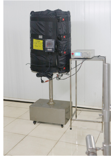
Messung des Isolationswiderstands nach IPx6-Tests
