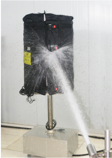
IPx6-Prüfung von Heizmänteln
